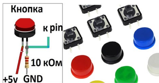
Рис. 1. Схема подключения тактовой кнопки к микроконтроллерной плате
