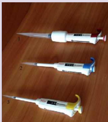
Рис. 5. Пипетки дозаторы одноканальные переменного объёма: 1 — 110 мл; 2 — 100—1000 мкл; 3 — 10—100
