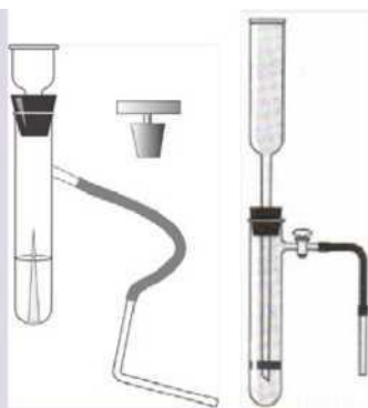
Рис. 7. Прибор для получения и собирания газов
